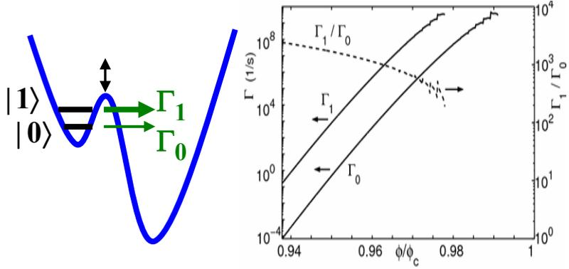
$$\text{Error} \approx (\Gamma_0 / \Gamma_1) [1 + \ln(\Gamma_1 / \Gamma_0)]$$
